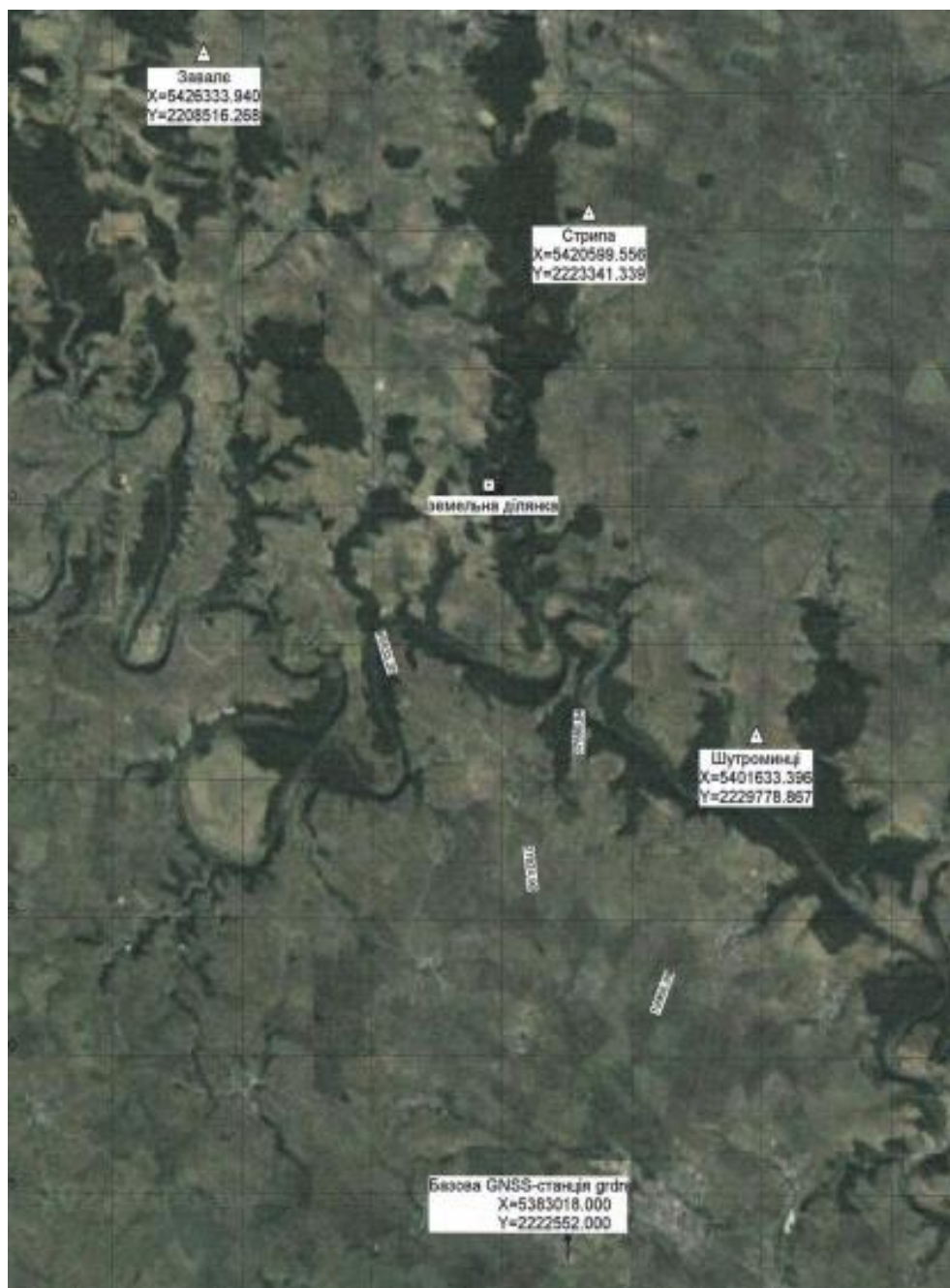
Рис. 2.1 Схеми GNSS спостережень з привязкою до пунктів ДГМ при перенесенні меж земельної ділянки
