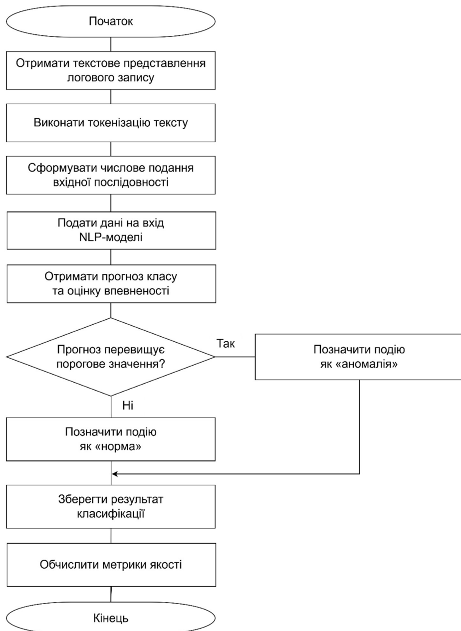
Рисунок 2.6 – Схема алгоритму NLP-класифікації мережевого логу
