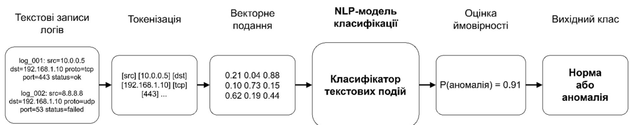
Рисунок 2.3 – Структура модуля NLP-аналізу та виявлення аномалій
