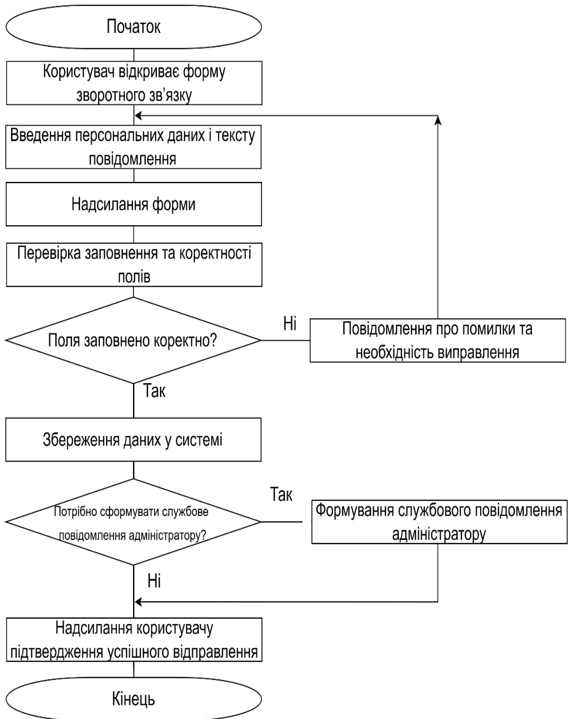
Рисунок 2.8 – Схема алгоритму оброблення повідомлень із форм зворотного зв'язку
