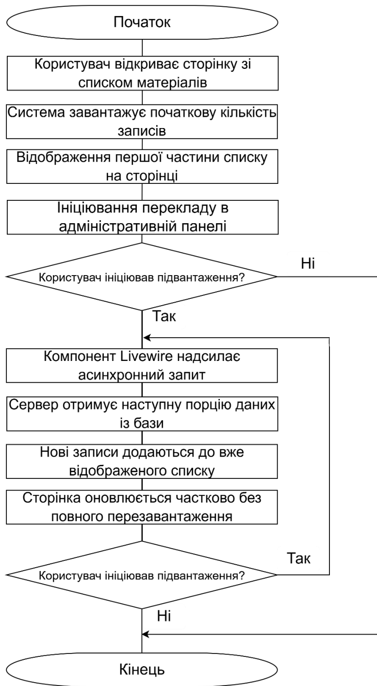
Рисунок 2.7 – Схема алгоритму динамічного підвантаження даних
