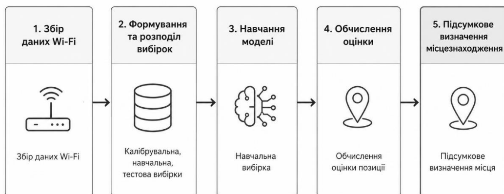
Рисунок 1.3 – Узагальнена схема надійного Wi-Fi-позиціонування на основі RTT і RSS
