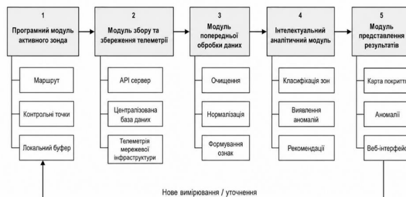
Рисунок 3.3 – Структура реалізованих модулів системи моніторингу Wi-Fi-покриття
