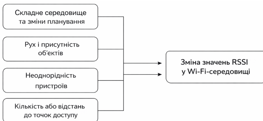
Рисунок 1.2 – Схема чинників, що впливають на значення RSSI у Wi-Fi-середовищі
