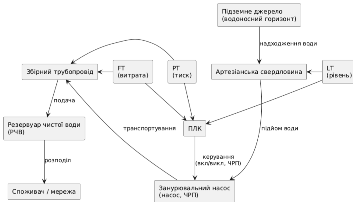
Рисунок 1.5 – Схема водозабору підземних вод
