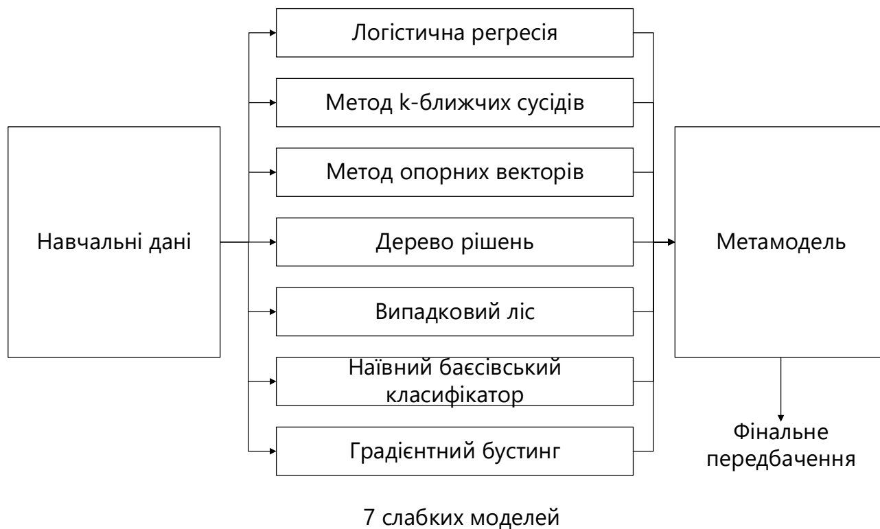
Рисунок 3.1 – Застосування методу стекування із використанням семи класифікаторів, кожен з яких виконує роль слабого навчального алгоритму
