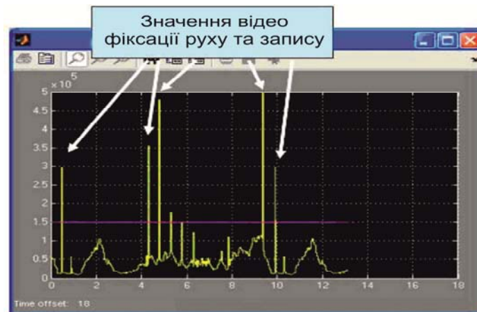
Рисунок 3.18 – Виявлення та реєстрація переміщення на заборонний сигнал світлофора в Simulink-моделі відеоспостережної системи
