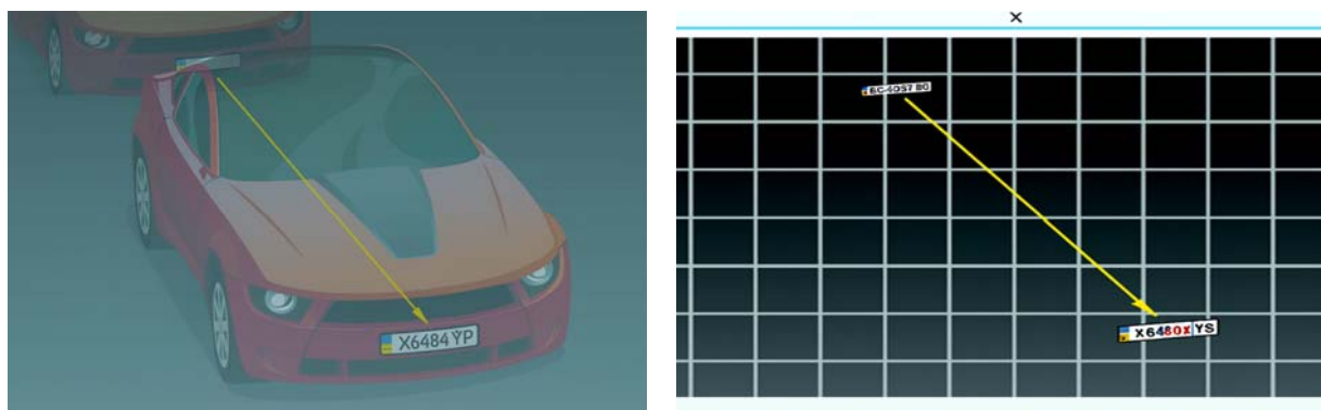
Рисунок 1.13- Алгоритм відтворення вектора для обчислення швидкості
