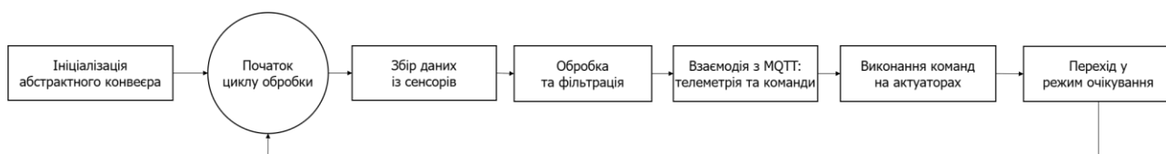
Рисунок 2 – Блок-схема роботи дворівневого життєвого циклу програмного забезпечення IoT-вузла
