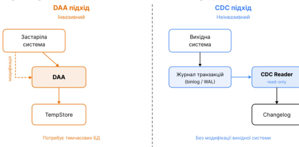
Рисунок 1 – Порівняння підходів DAA і CDC до журналювання змін у вихідній системі
