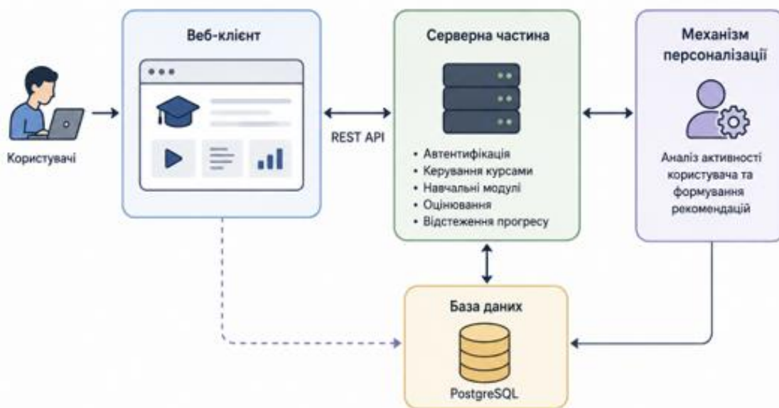
Рисунок 1 - Клієнт-серверна архітектура та функціональна схема системи онлайн-навчання
