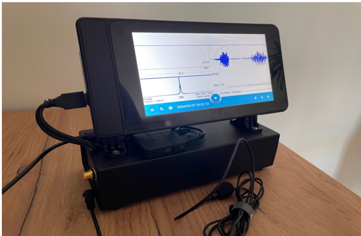
Рис. 4.1. Розроблений пристрій для інтраопераційного моніторингу ПГН в процесі проведення операцій на щитоподібній залозі із додатковими функціями
