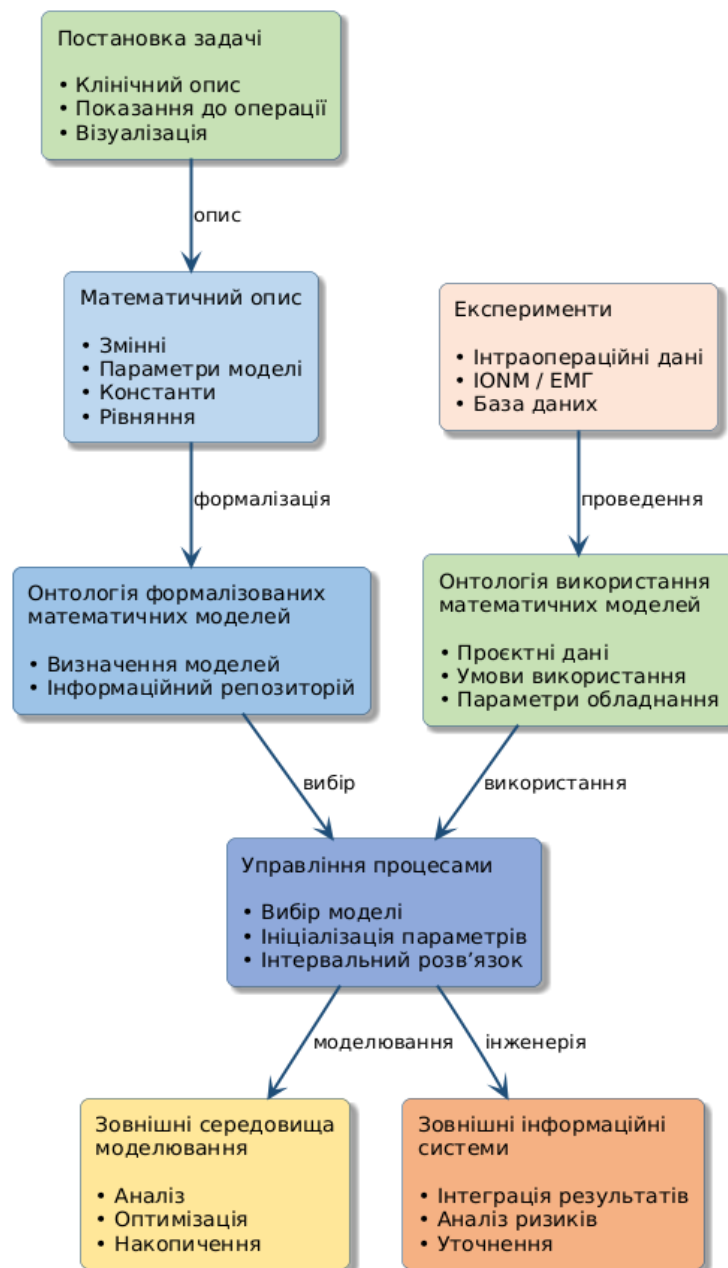
Рис. 2.2. Загальна схема реалізації прикладної онтології в ІТ інтраопераційного нейромоніторингу
