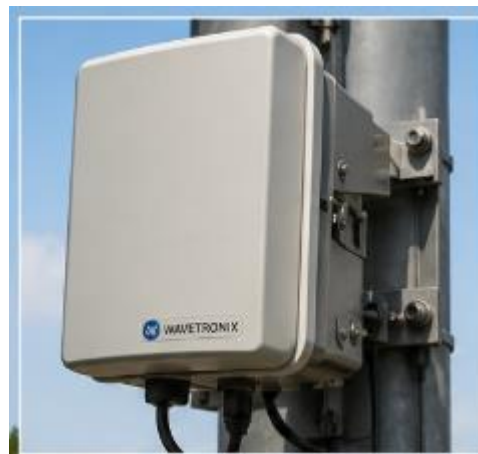
Рисунок 2.7 – Радарний сенсор Wavetronix SmartSensor HD у системі моніторингу транспортного потоку
