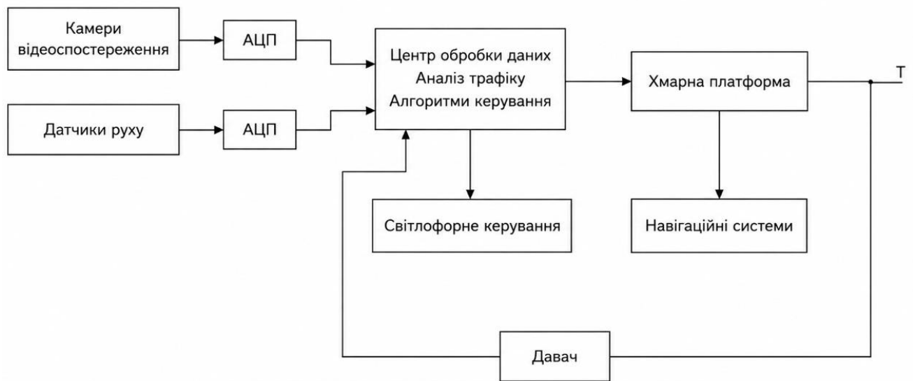
Рисунок 1.2 – Структура інтелектуальної системи керування дорожнім рухом
