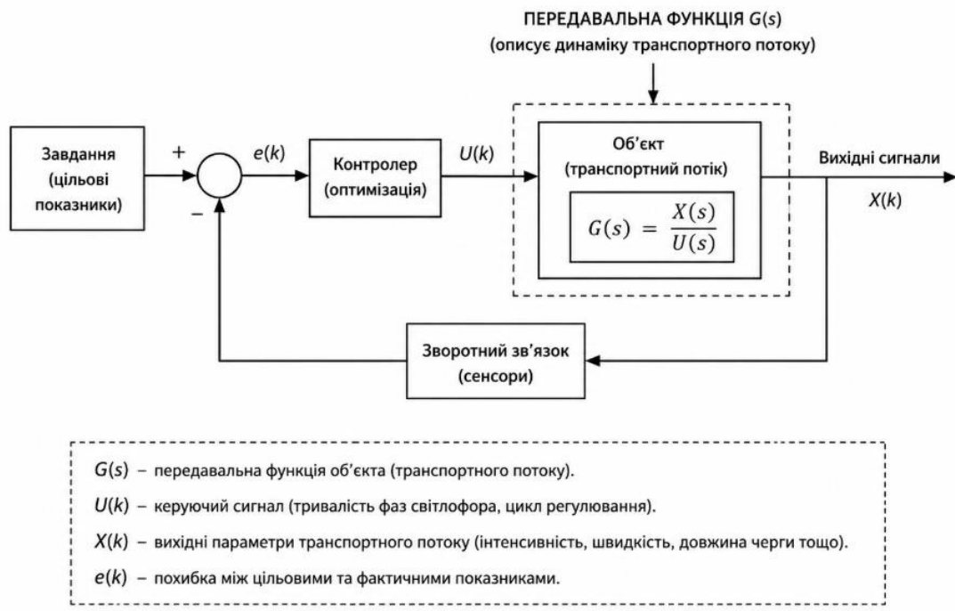
Рисунок 3.5 – Дискретний контур керування транспортним потоком із зворотним зв'язком
