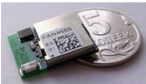
Рисунок 2.3 – ZigBee-модуль PAN4555 з вбудованим мікроконтролером від Panasonic
