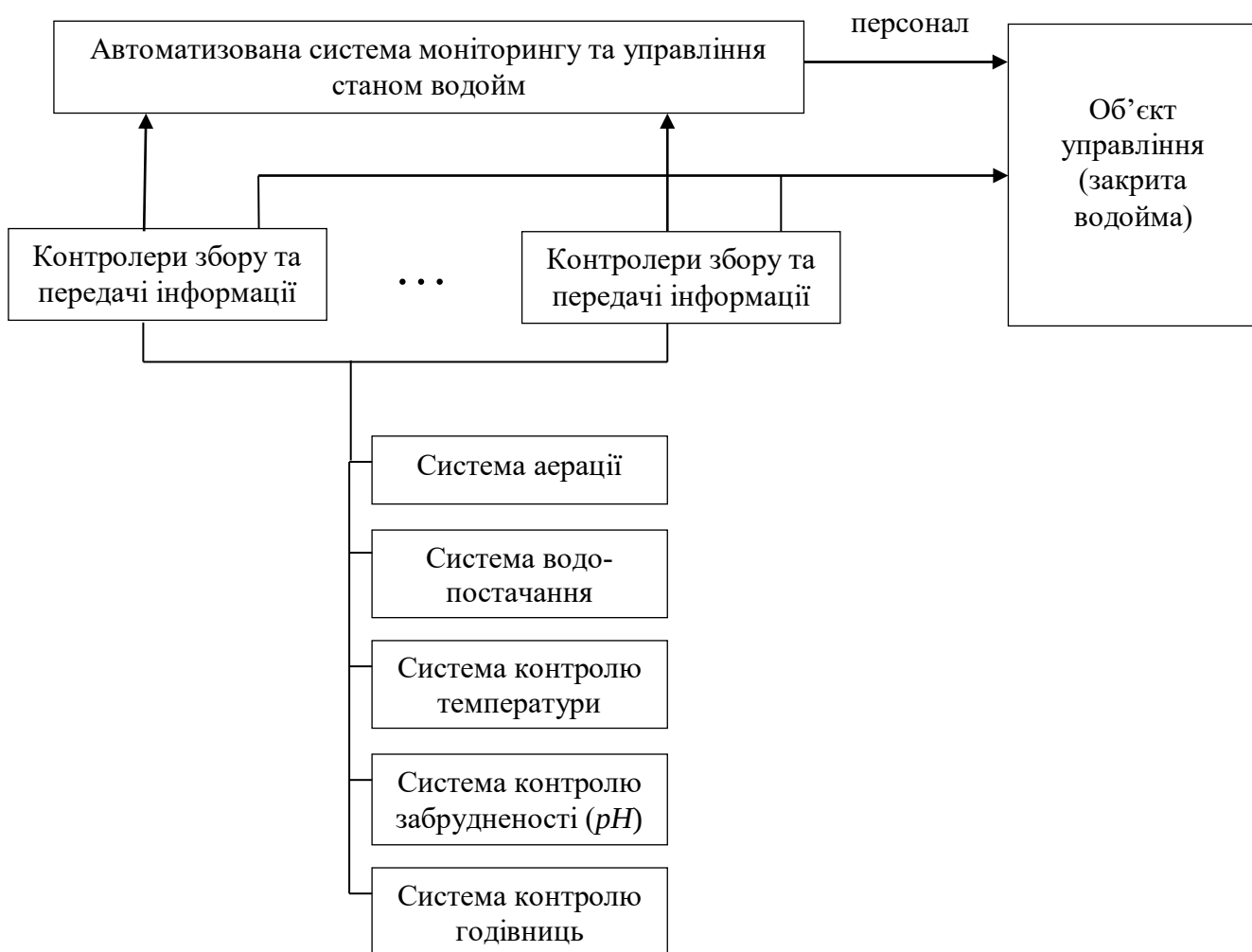
Рисунок 2.1 – Узагальнена структура автоматизованої системи
