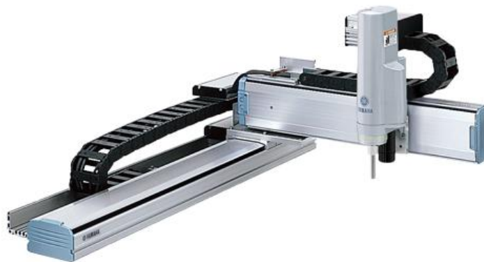
Рисунок 1.3. – Декартовий робот Yamaha XY-X Series
