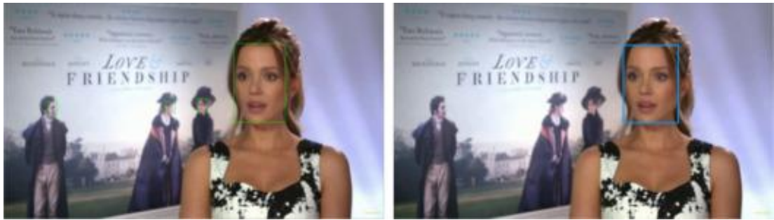
Рисунок 2.2 - Обличчя, розпізнані S3fd, позначені зеленою рамкою (ліворуч), обличчя, розпізнані Mtcnn, позначені синьою рамкою (праворуч)
