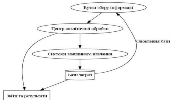
Рисунок 2 - Архітектура розподіленої системи моніторингу
