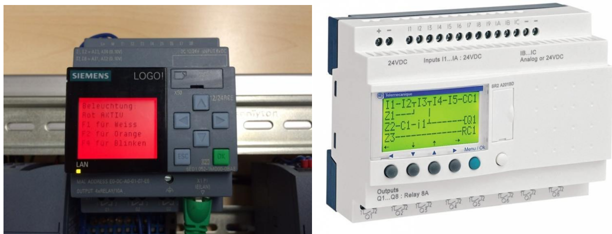
Рисунок 2.2 – ПЛК типу Siemens LOGO!, Schneider Electric Zelio.
