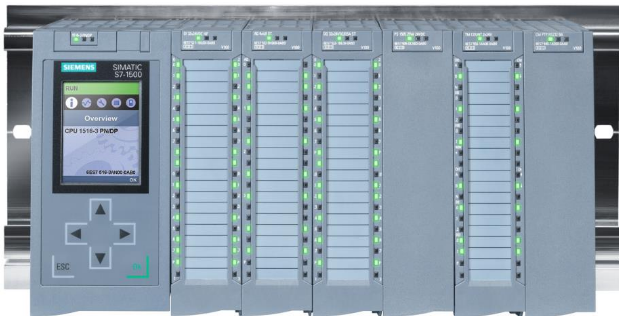
Рисунок 2.3 – Загальний вигляд програмований логічний контролер Simatic S7-1500
