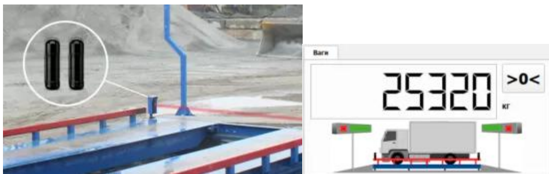
Рисунок 2.11 – Розміщення датчиків контролю положення
