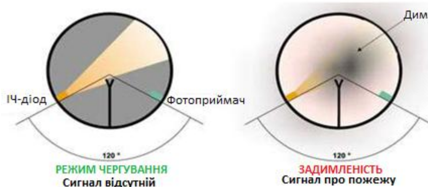
Рисунок 2.20 – Принцип роботи оптичних датчиків диму
