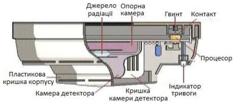
Рисунок 2.18 - Будова датчика диму
