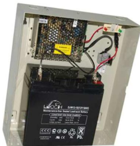
Рисунок 2.22 - Зовнішній вигляд блоку живлення
