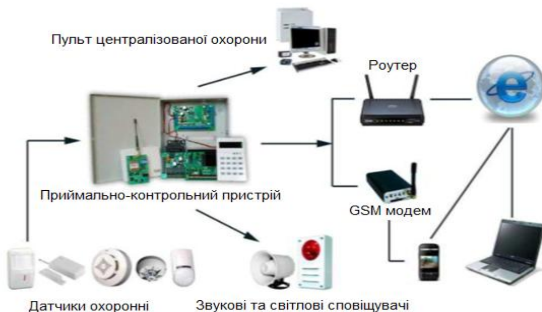
Рисунок 2.1 - Типова схема побудови БСОС
