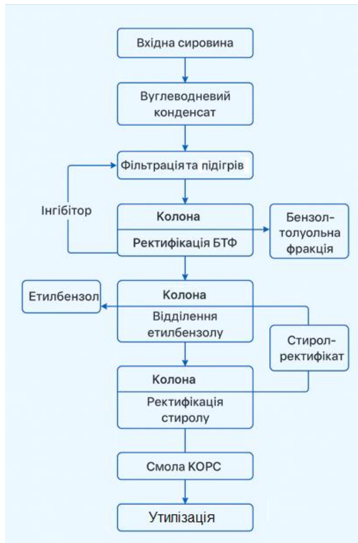
Рисунок 1.2 - Структура технологічного процесу ректифікації
