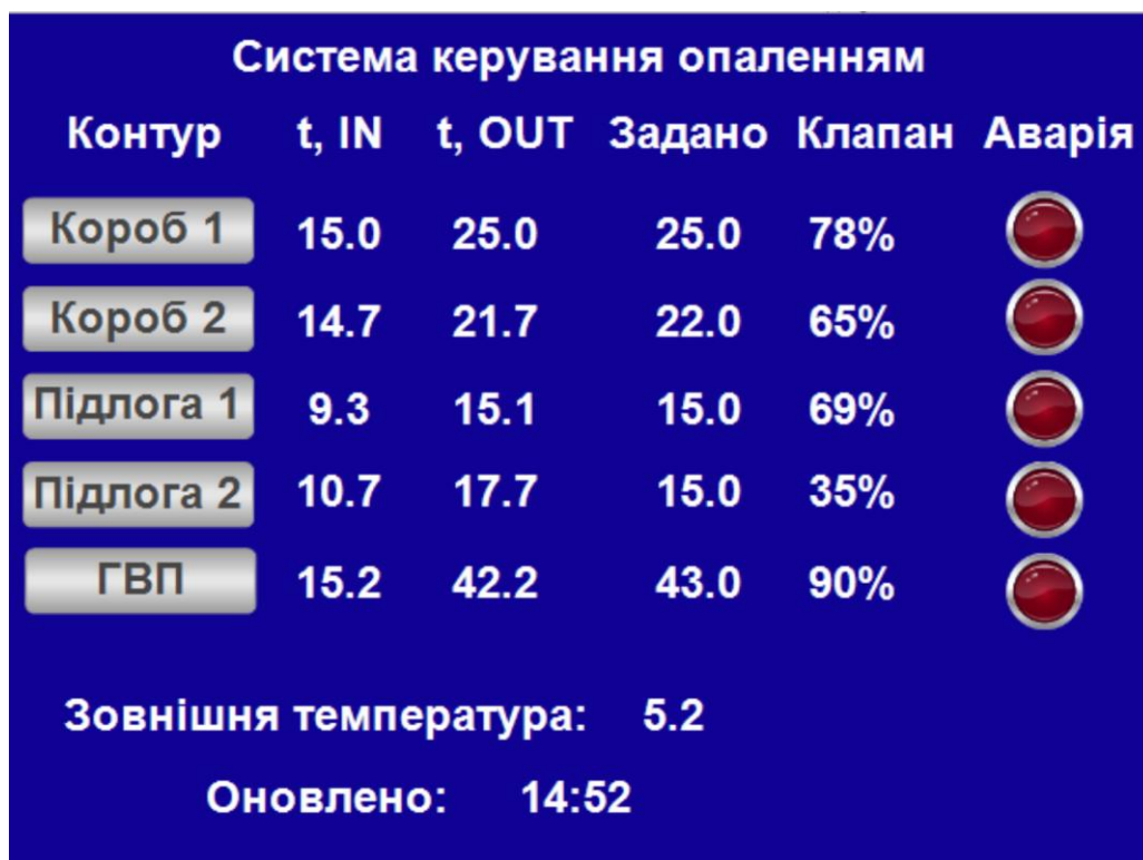
Рисунок 3.12 – Головне вікно візуалізації HMI
