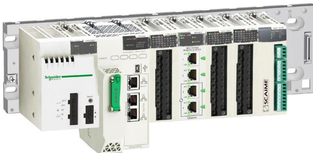
Рисунок 2.2 – Загальний вигляд промислового ПЛК Schneider Electric Modicon M580 для АСКЗЕ
