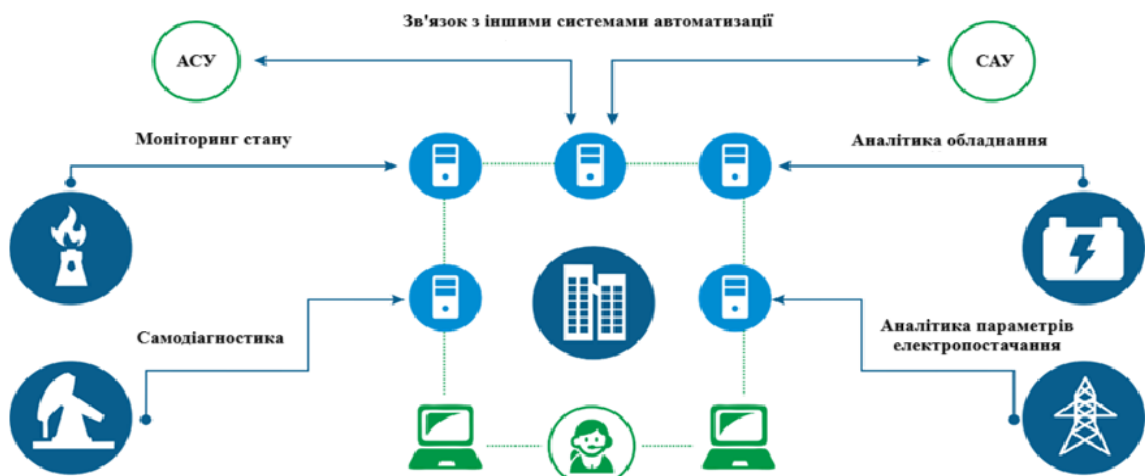
Рисунок 1.3 – Загальна структура автоматизованої системи моніторингу електрообладнання
