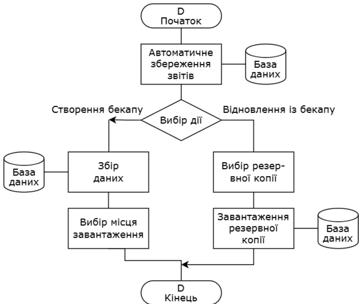
Рисунок 2.7 – Схема алгоритму модуля управління резервними даними
