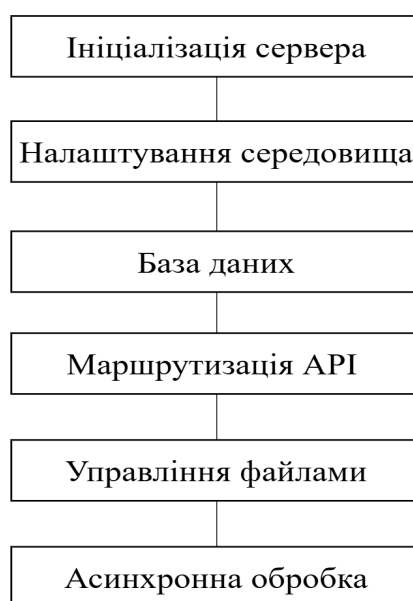
Рисунок 3.7 – Архітектура API-сервера модуля обліку робочого часу
