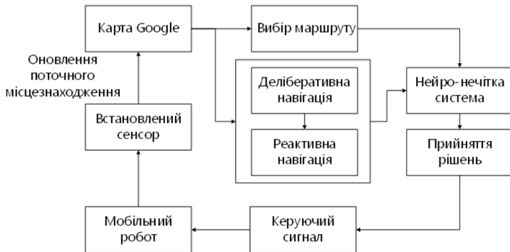
Рисунок 1 – Архітектура модуля для автономного управління рухом мобільного робота
