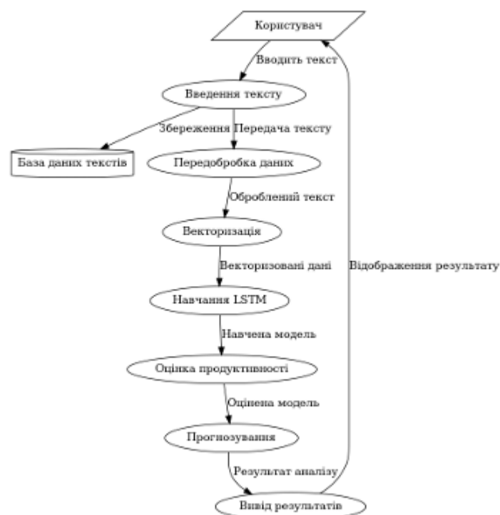
Рисунок 1 – Архітектура нейромережевого модуля визначення джерела тексту з використанням Embedding та LSTM
