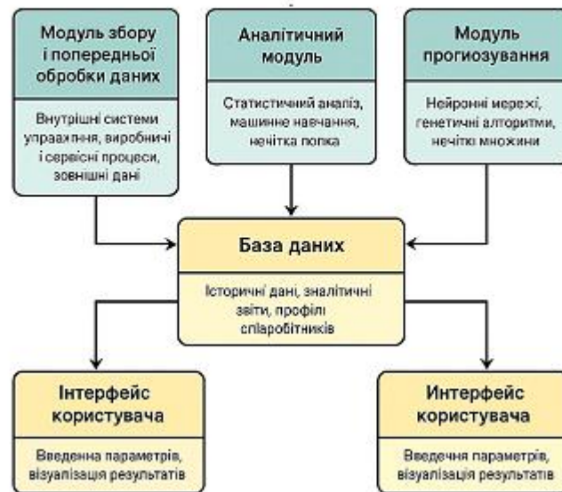
Рисунок 2.1 - Загальна структура проектованого модуля
